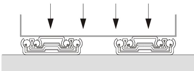
1 paio di guide montate in senso orizzontale
