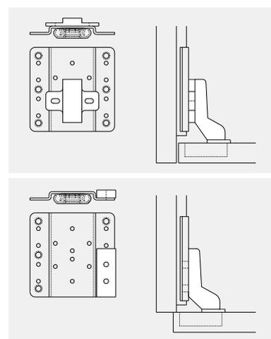
A seconda del tipo di cherniera il sistema per porte scorrevoli può essere montato per ottenere l'apertura o la chiusura delle porte.
