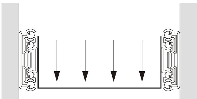
1 paio di guide montate in senso verticale
