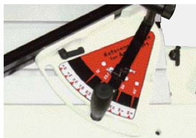
Posizione della squadra da 45° a partire da 15° - 90° - 135°, con fermi per posizione 0° regolabili
