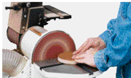
Puntale fornito standard per levigare profili circolari
