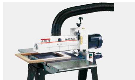
Calibra 810 mm in due passate, la rigidità del sistema e la regolazione del parallelismo permette di azzerare il dislivello tra le due passate
