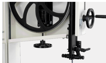
Ruote in ghisa bilanciate e ricoperte da resina PU curva in modo che i denti della lama non rovinino la copertura
