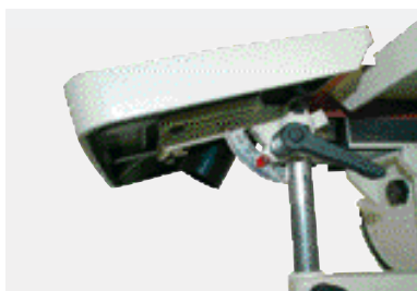
Inclinabile 0-45° con bocchetta di aspirazione Ø 50 mm
