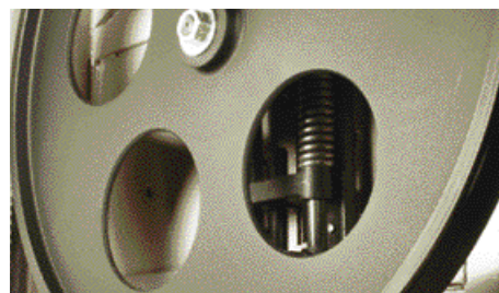
Ruote in ghisa bilanciate e ricoperte da resina PU curva in modo che i denti della lama non rovinino la copertura
