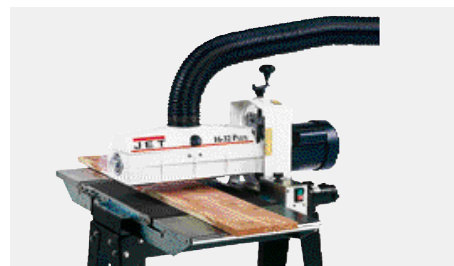
Calibra 405 mm in una sola passata, la rigidità di questa macchina garantisce che anche con lo sforzo di lavoro non fletta il gruppo di levigatura
