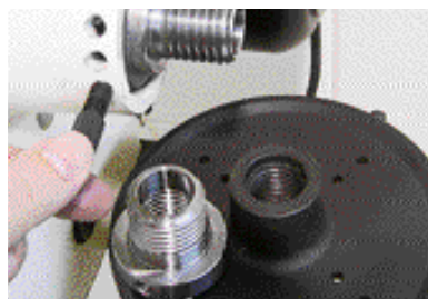
Il gruppo testa permette di bloccare l'albero mandrino ogni 15°
