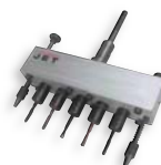
10003351 Foratrice multipla a interasse 32 mm Per la foratura degli armadi 5x32 mm – incluse punte in HM 5 x Ø 5 mm e 2 puntali di riferimento telescopici
