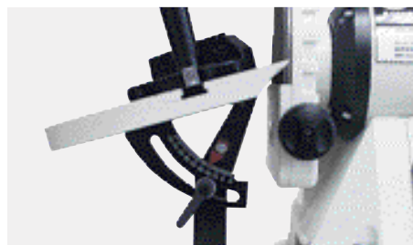
Tavola inclinabile da 90° a 45° con fermi corsa
