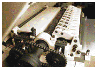
Rullo ingresso segmentato anti espulsione e albero pialla con inserti
