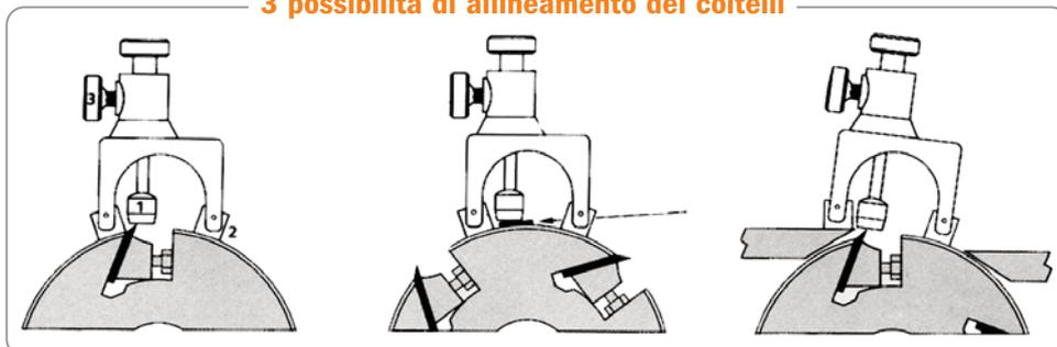
Allineamento sul corpo della testa con rilevamento sul coltello originale.
