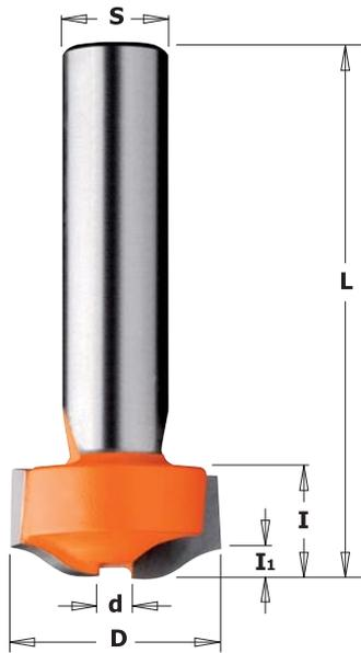
Questa fresa è stata progettata per realizzare bordi salva goccia per i top delle cucine e bagni in un solo passaggio. Da utilizzare su elettrofresatrici portatili e da banco. Inoltre questo utensile è capace di realizzare profili interni ed esterni creando bordi leggermente rialzati per evitare la fuoriuscita di eventuali liquidi.
