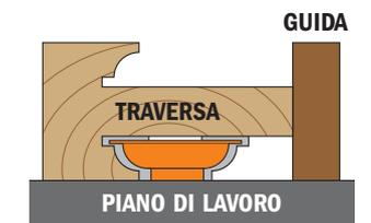
**Passo 3.** Fresate nella parte inferiore del tenone per realizzare la fine della traversa.
