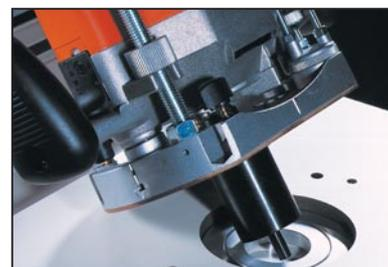
**999.502.34** Perno di centraggio dell'elettrofresatrice sulla piastra del piano di lavoro.
