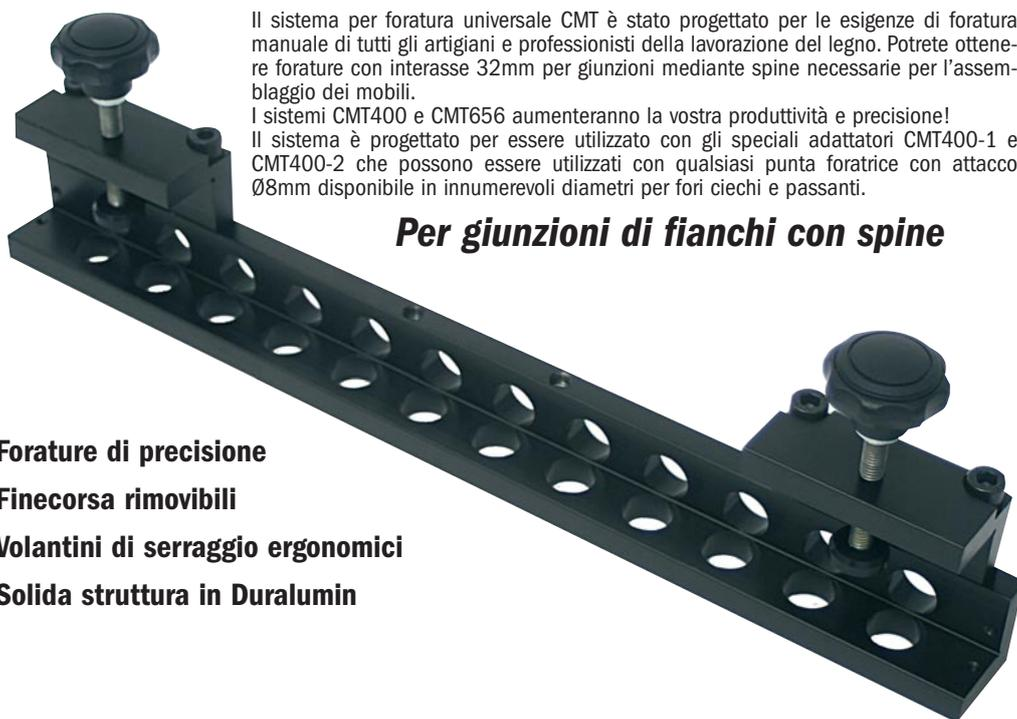
Il sistema per foratura universale CMT è stato progettato per le esigenze di foratura manuale di tutti gli artigiani e professionisti della lavorazione del legno. Potrete ottenere forature con interasse 32mm per giunzioni mediante spine necessarie per l'assemblaggio dei mobili.
