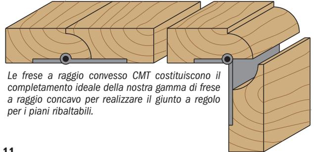
Le frese a raggio convesso CMT costituiscono il completamento ideale della nostra gamma di frese a raggio concavo per realizzare il giunto a regolo per i piani ribaltabili.
